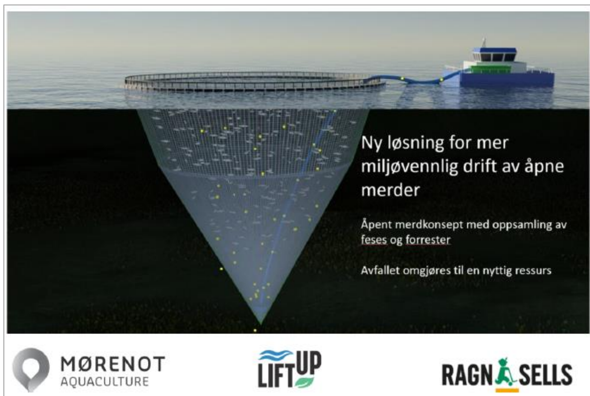
Figur 6-4. Illustrasjon av konsept for slamoppfangning som er stilt som krav for to helt nye anlegg. Illustrasjon fra Mørenot Aquaculture.
